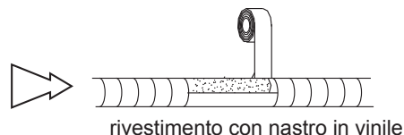
rivestimento con nastro in vinile
